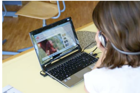
Geräte mit Kensington-Schlössern gesichert
